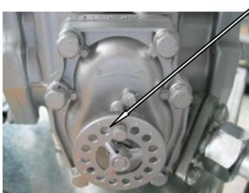
Рисунки 9,10 – Пломбировка регулировочного винта (при наличии) и измерителя объема
