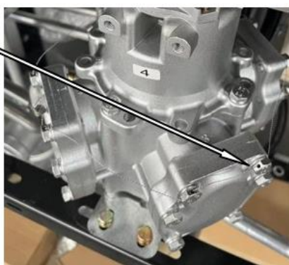
Рисунки 9,10 – Пломбировка регулировочного винта (при наличии) и измерителя объема
