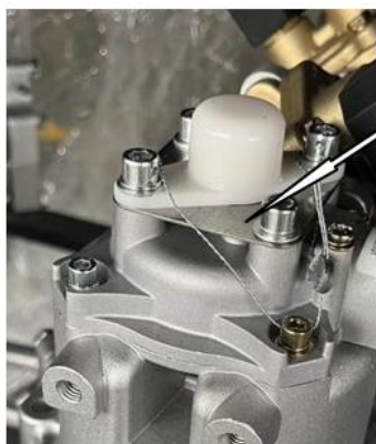
Рисунок 7 – Пломбировка генератора импульсов
